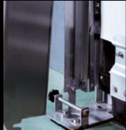
Die Verriegelung der Zargendeckel kann im Handumdrehen gelöst werden und zur leichten Reinigung können diese geöffnet und arretiert werden. So ist der gesamte Innenraum mit dem Dampfstrahler bestens zu erreichen.
