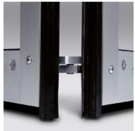
Die Flügel von Schnelllauf-Falttören sind mit einem EFAFLEX-Kardangelenk verbunden. Die Torflügel sind gegeneinander so kardanisches aufgehängt, dass es nicht zu Spannungen kommen kann. Das garantiert über Jahre hinweg wartungsarmen und störungsfreien Betrieb.
